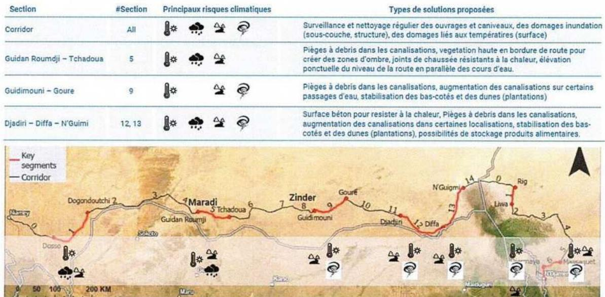
Figure 7. Synthèse des risques climatiques sur les tronçons autour de la RN1 et exemples de mesures de résilience pour le projet
